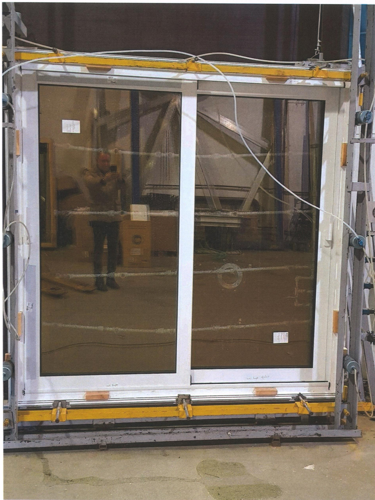
Рис.5 Внешний вид блока оконного при проведении испытания на воздухо- водопроницаемость
