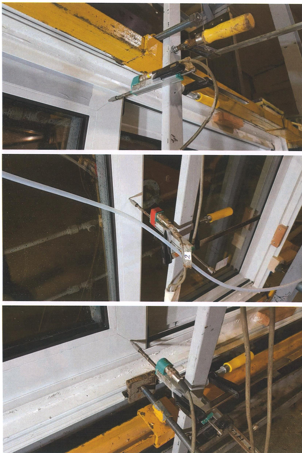
Рис. 7 Расположение датчиков линейных перемещений
