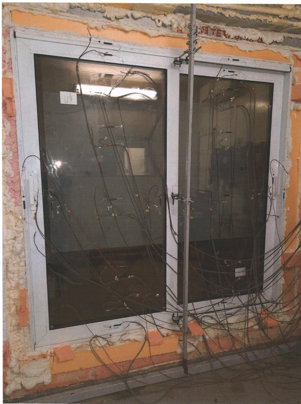
Рис.3 Внешний вид блока оконного, установленного в климатической камере.
