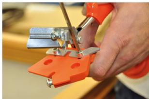
Отрегулируйте стопорную пластину на желаемую ширину уплотнителя
