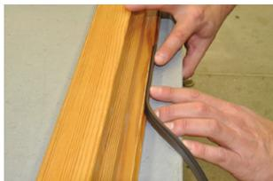
Вставить уплотнитель на середине верхней части створки и закатать в паз до первого угла створки
