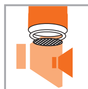
Аэратор пластиковый со специальной сеткой для снижения шума
